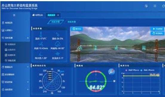
舟山跨海大橋健康監測系統介面
